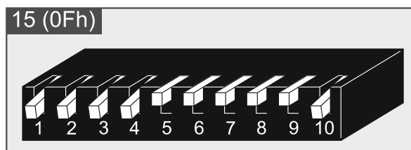
Rys. 11. Sposób ustawienia przełączników DIP-switch w ekspanderze INT-ORS.
