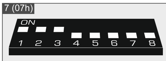
Rys. 6. Sposób ustawienia przełączników DIP-switch w ekspanderze INT-RX-S.
