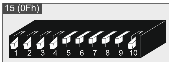
Rys. 11. Sposób ustawienia przełączników DIP-switch w ekspanderze INT-ORS.
