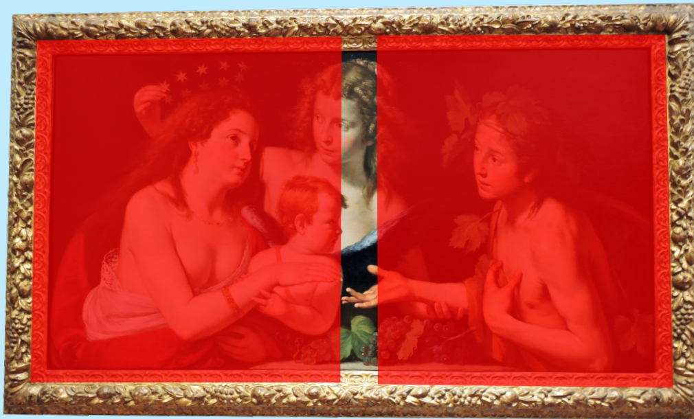
Anordnung der Sensorflächen hinter Gemälde
