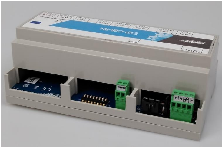
2 EXP-O8R-RN-D9M widok od strony złącz zasilania i komunikacji.
