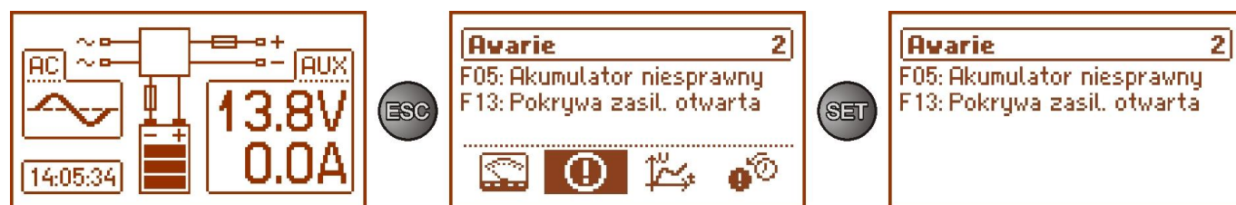
Rys. 10. Ekran – bieżące awarie zasilacza.
