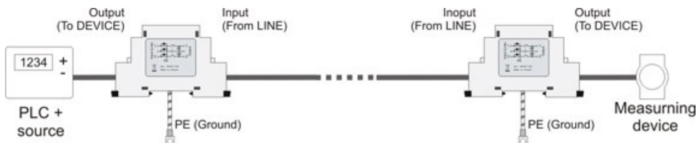
Schemat prawidłowego zabezpieczenia pętli prądowej
